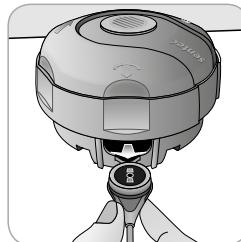
Znovu stiskněte nebo nadzdvíhněte senzor pro jeho uvolnění a vyjměte jej z Membránového Changeru.
