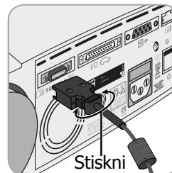
Odpojte kabel od SDM stisknutím dvou pojistek na zástrčce, pro uvolnění svorky (viz obrázek) a zatáhněte za kabel.
