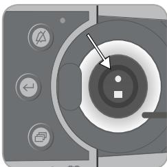
**2.** Zkontrolujte těsnění (šipka) na dokovací stanici. Pokud je to nutné, očistěte dokovací stanici a těsnění vatovým tampónkem navlhčeným 70% isopropanolem (nebo jiným schváleným čisticím prostředkem viz technický manuál SDM).
