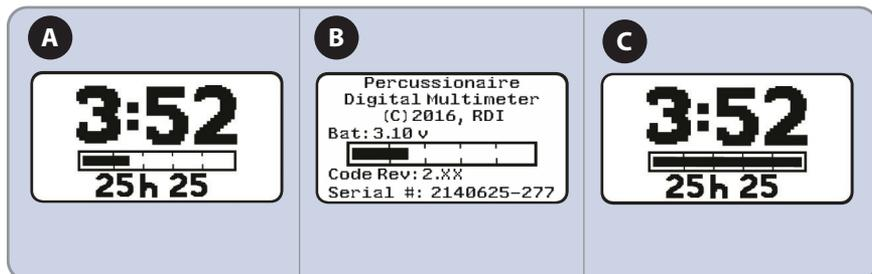
Durante o período de 5 minutos, um gráfico de barras horizontais indica o tempo, movendo-se da esquerda para a direita a uma velocidade fixa. Após 5 minutos sem utilização, a página de informações do sistema deixa de ser apresentada e o visor do tempo **(C)** fica intermitente, 2 segundos ligado, 2 segundos desligado, durante mais 25 minutos. O visor entra no modo Sleep (Espera) ao fim de 25 minutos.
