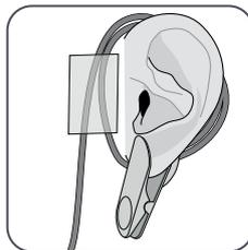
**11.** Enrole o cabo do sensor uma vez em torno da orelha e fixe o cabo na bochecha como mostrado na imagem. Coloque o cabo do sensor adequadamente para evitar emaranhamento ou compressão e prenda-o com um grampo de vestuário num local adequado na roupa do doente ou na roupa de cama. Certifique-se de que o cabo do sensor apresenta folga suficiente para não ser esticado durante a monitorização. Aperte gentilmente o sensor e o Clip de Orelha como uma última verificação de aplicação.
