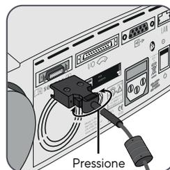
Ligue o Cabo Adaptador do Sensor Digital ao SDM. A ligação é estabelecida de forma adequada quando os dois grampos da fixa se fixarem na porta de ligação do sensor (15).
