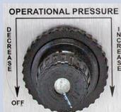
Le bouton **Operational Pressure (Pression de fonctionnement)** commande la pression de fonctionnement maximale de l'ensemble de l'appareil.
