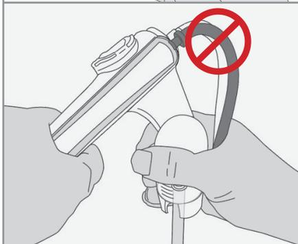
**⚠ ATTENTION :** Ne pas plier le bol du nébuliseur en tenant la tubulure. Cela peut causer une contrainte indue sur le connecteur conique de la tubulure rouge.
