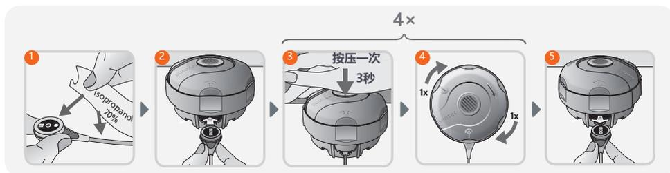
在SDM没有提示更换薄膜但出现下列情况下，也必须另外更换传感器薄膜：如果传感器薄膜损坏或缺失，薄膜出现松动或在膜片下有滞留的空气或膜下电解液已经出现干结。
